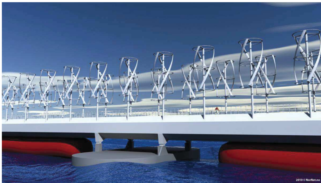
Figur 19: Illustrasjon på bruk av flere små turbiner, her vertikale. Illustration: NorNet.no
